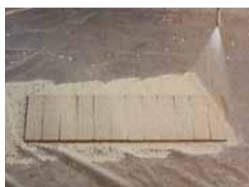
Essais en laboratoire pour l'application avec machine au moyen de la technique de pulvérisation.
